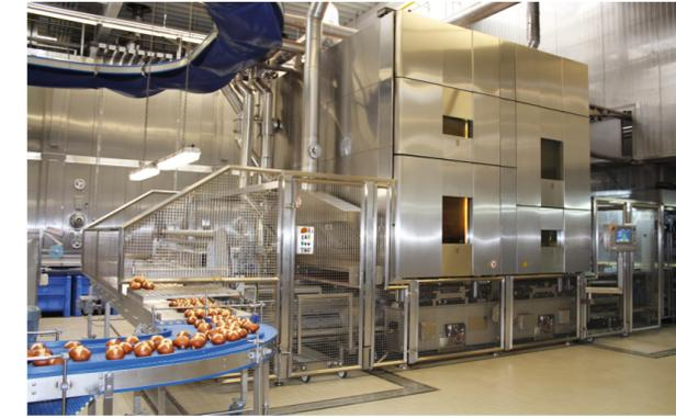
++ Industriebackofen PU Integral von König im laufenden Betrieb
