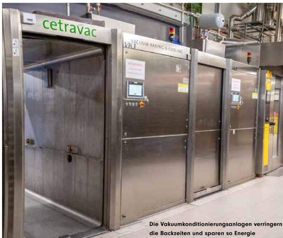
Die Vakuumkonditionierungsanlagen verringern die Backzeiten und sparen so Energie
