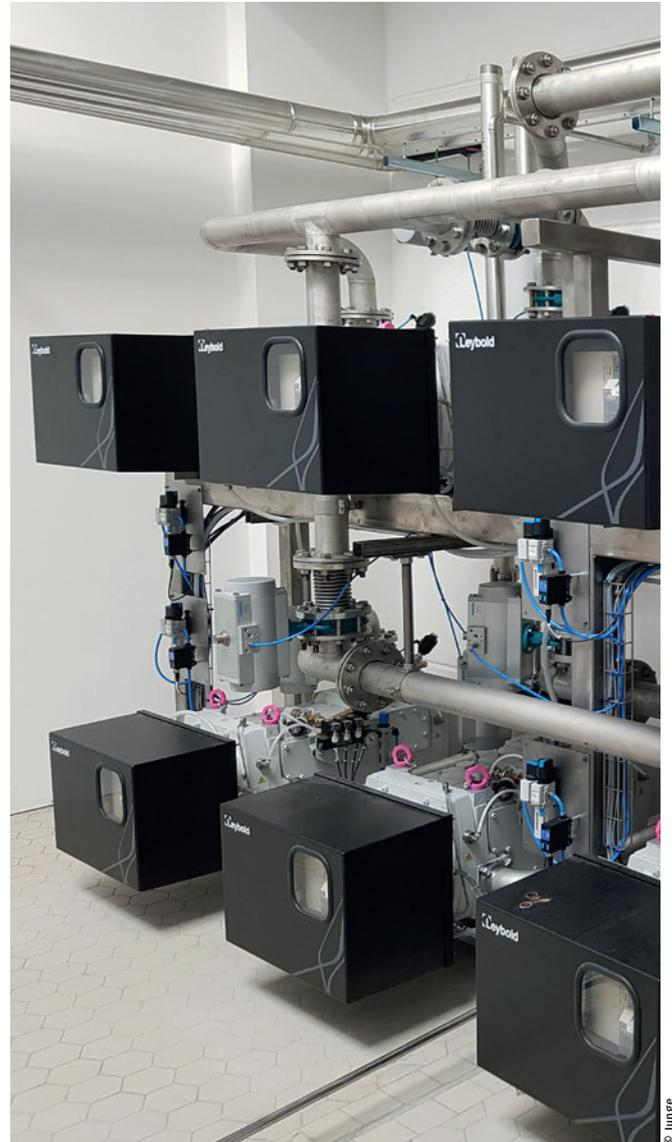
++ 6 Vakuumpumpen für 5 Kammern, d.h. 100% Betriebssicherheit rund um die Uhr bei vergleichsweise geringem Energieverbrauch: nur ca. € 0,18 pro 1000 Stück Kleingebäck dank der nur von Cetravac eingesetzten Pumpenkombination
