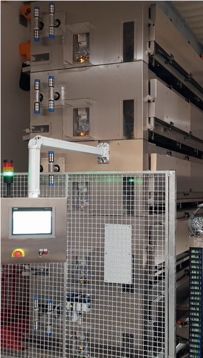
++ Mit 5 Vakuumkammern übereinander werden 1,5 to vorgebackenes Kleingebäck (ohne Farbe) konditioniert, 24 Stunden/ Tag, für perfekte Frische, Rösche und Volume und mindestens 3 Tage MHD ohne Kühlung/Tiefkühlung
